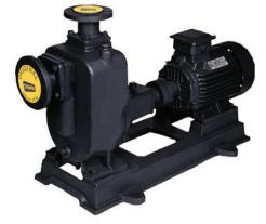
Menggunakan mechanical seal dari keramik untuk menahan cairan berpasir agar tidak masuk ke permukaan penyegelan dan mencegah terjadinya goresan
